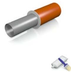
Kleineres Rohr in den Gummiadapter schieben.
