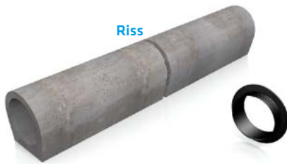
Defekte Leitung heraustrennen.
