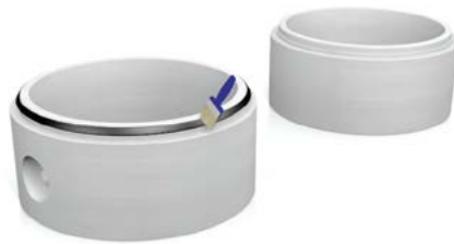
Gleitmittel auf Dichtung auftragen.
